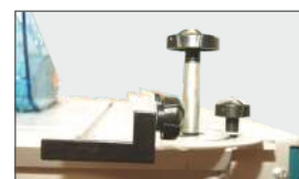
Ghidajul adaptor permite tăieri pentru grosimi diferite ale materialului
