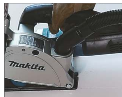
Se poate conecta la un aspirator de praf
